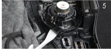
Der Lautsprecher ist nun zugänglich. Da der Lautsprecher nicht verschraubt ist, können Sie diesen einfach heraus hebeln und entfernen. *The speaker is accessible. The speaker is not screwed. Lever out the speaker and remove it.*
