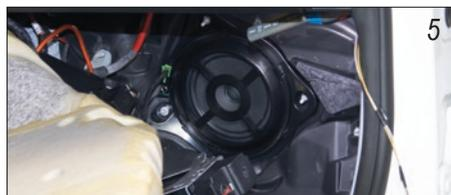
Lösen Sie die drei Muttern (10er) hinter der Abdeckung des Fußraums (gesteckt und geschraubt) (Bild 3). Entfernen Sie das Steuergerät und den Stromverteilerkasten vor dem alten Woofer. Der Woofer ist nun zugänglich. *Loosen the three nuts (10) behind the cover of the footwell (inserted and screwed) (Picture 3). Remove the controller and power distribution box in front of the woofer. The woofer is now accessible.*
