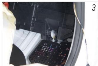
Entfernen Sie die Türleiste und die Abdeckung unter dem Handschuhfach (Abdeckung mit Schraube und Klips befestigt). Falls vorhanden, die Stecker von der Abdeckung entfernen. *Remove the door strip and the cover under the glove compartment (cover fixed with a screw and clips). If available, loosen the plugs of the cover.*
