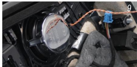
Verbinden Sie das Kabel des Hochtöners mit der Zuleitung und dem Musway Lautsprecher. Montieren Sie die Türverkleidung in umgekehrter Reihenfolge. *Connect the tweeter cable to the factory cable and the Musway speaker. Mount the door trim in reverse order.*
