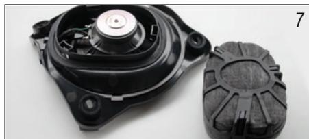
Lösen Sie nun den Stecker vom Subwoofer und bauen Sie dann den alten Woofer aus (3 x verschraubt). Entfernen Sie vom alten Subwoofer die hintere Abdeckung. *Now disconnect the plug and remove the woofer (3 x screwed). Remove the rear cover from the old woofer.*
