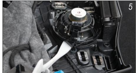
Der Lautsprecher ist nun zugänglich. Da der Lautsprecher nicht verschraubt ist, können Sie diesen einfach heraushebeln und entfernen.
