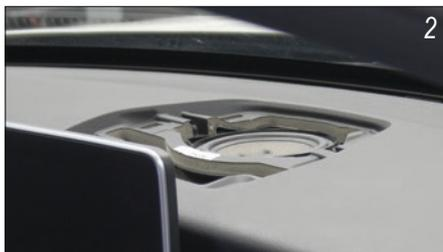
Hebeln Sie das Lautsprechergitter heraus. Danach lösen Sie den alten Lautsprecher (heraushebeln, nicht verschraubt).
