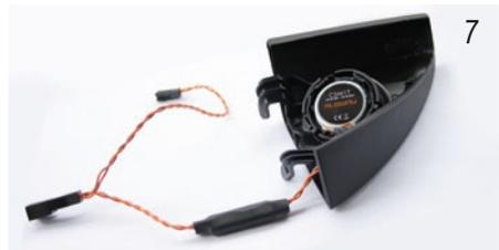
Nun montieren Sie den Musway Lautsprecher, indem Sie diesen in den Steckplatz hineindrücken. Entfernen Sie nun den alten Hochtöner aus dem Spiegeldreieck (falls vorhanden). Befestigen Sie dann den Musway Hochtöner. *Now mount the Musway speaker in the slot by pushing it in. Then remove the old tweeter from the mirror triangle, if available. Afterwards attach the Musway tweeter.*
