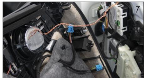
Befestigen Sie nun den Musway Lautsprecher und verbinden diesen mit dem Zuleitung ihres Fahrzeugs. Montieren Sie die Türverkleidung in umgekehrter Reihenfolge.
