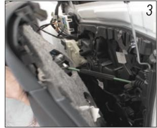
Entfernen Sie die zwei Schrauben am Türgriff (TX27). Hebeln Sie die Türverkleidung vorsichtig heraus (Von unten nach oben). Lösen Sie nun alle Stecker, die mit der Türverkleidung verbunden sind.
