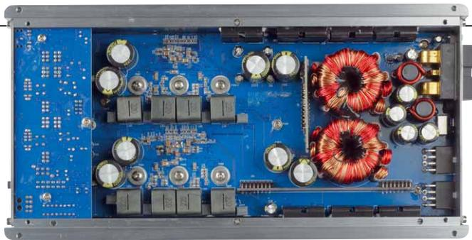
Großzügiges Doppelnetzteil bei der EIGHT100, die Verstärkung sitzt unterhalb der Platine, nur die Tiefpassspulen sind links zu sehen
